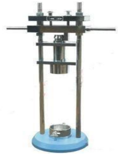
Fig 3.3 Impact Apparatus
