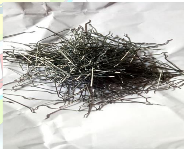
Fig.no.3.1: Steel fiber
