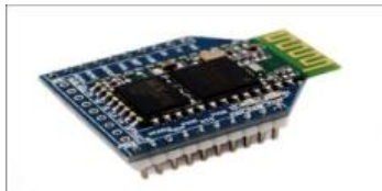
Fig.7. Bluetooth module
