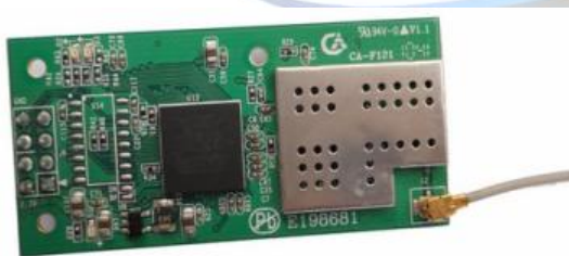
Fig.8. Bluetooth module.
