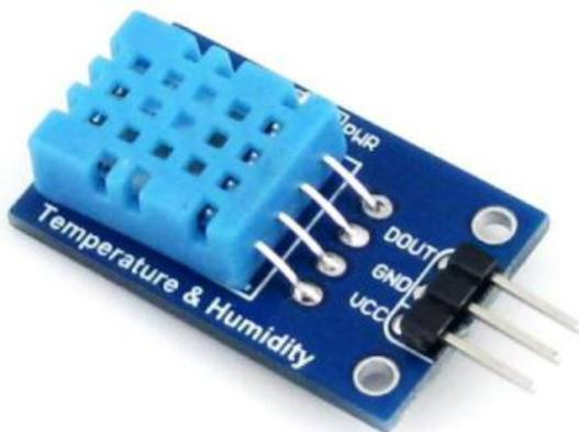
**Fig.3.14 DHT11 basic Temperature + Humidity sensor module**
