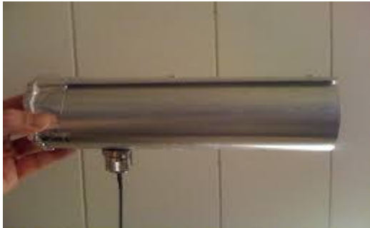
Fig.3 Cantenna
